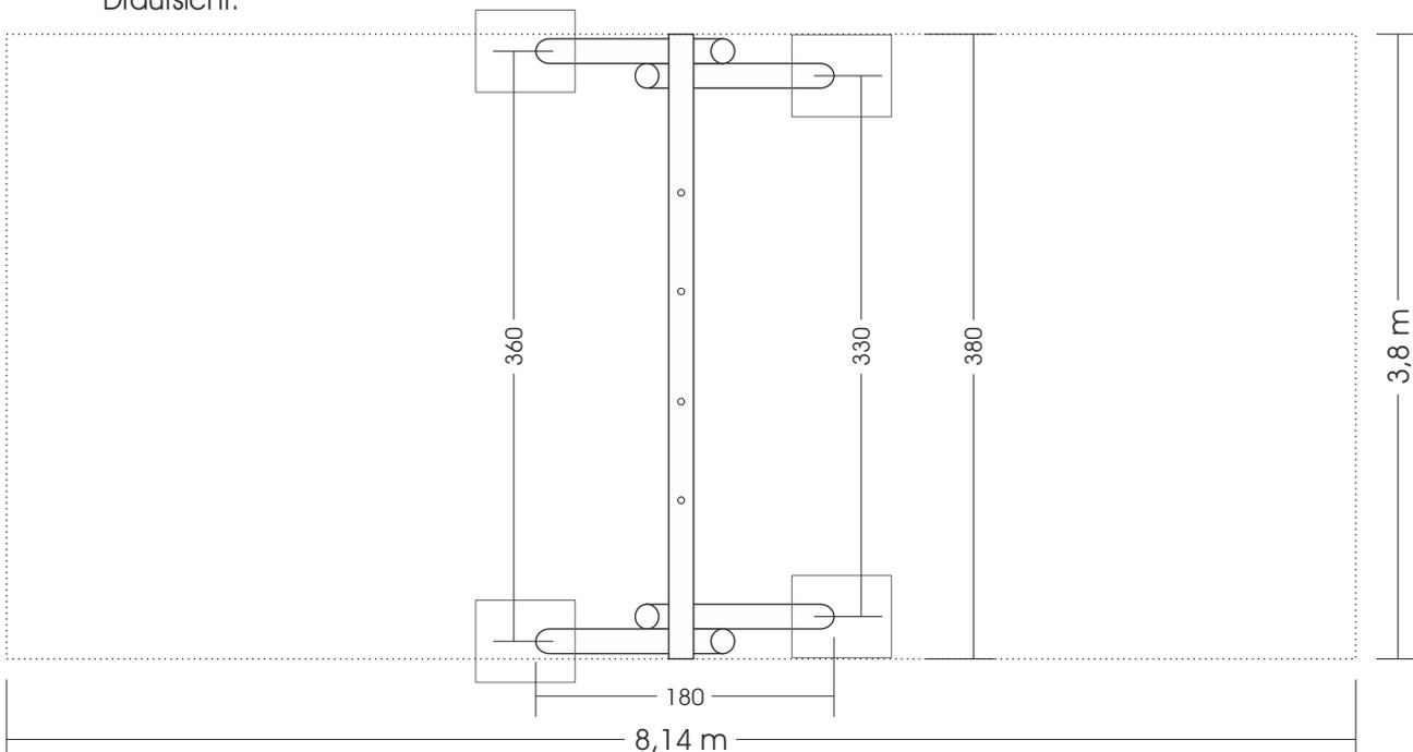
\* Zäune sollten in einem Abstand von mindestens 1,5m von der Seitenkante des Schaukelsitzes und, entsprechend einer Risikobeurteilung, 1,5m vom Rand der Aufprallfläche in Schaukelrichtung stehen. (DIN-EN 1176-2:2017-12 Anhang A)
