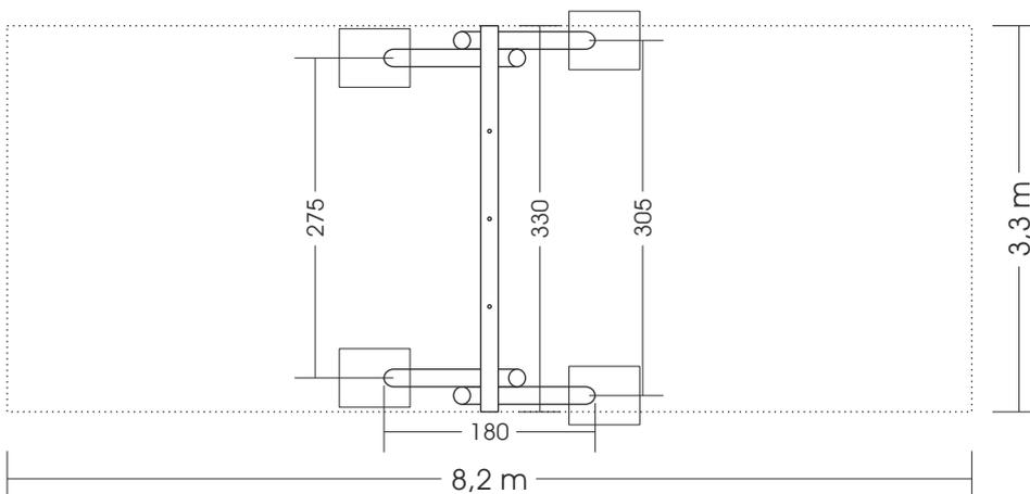
\* Zäune sollten in einem Abstand von mindestens 1,5m von der Seitenkante des Schaukelsitzes und, entsprechend einer Risikobeurteilung, 1,5m vom Rand der Aufprallfläche in Schaukelrichtung stehen. (DIN-EN 1176-2:2017-12 Anhang A)
